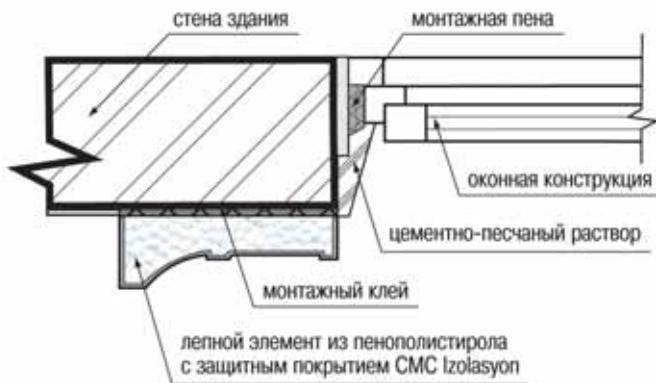
Через сутки после полного высыхания клей, вышедший из швов наружу, обрезается канцелярским ножом по контуру детали.
